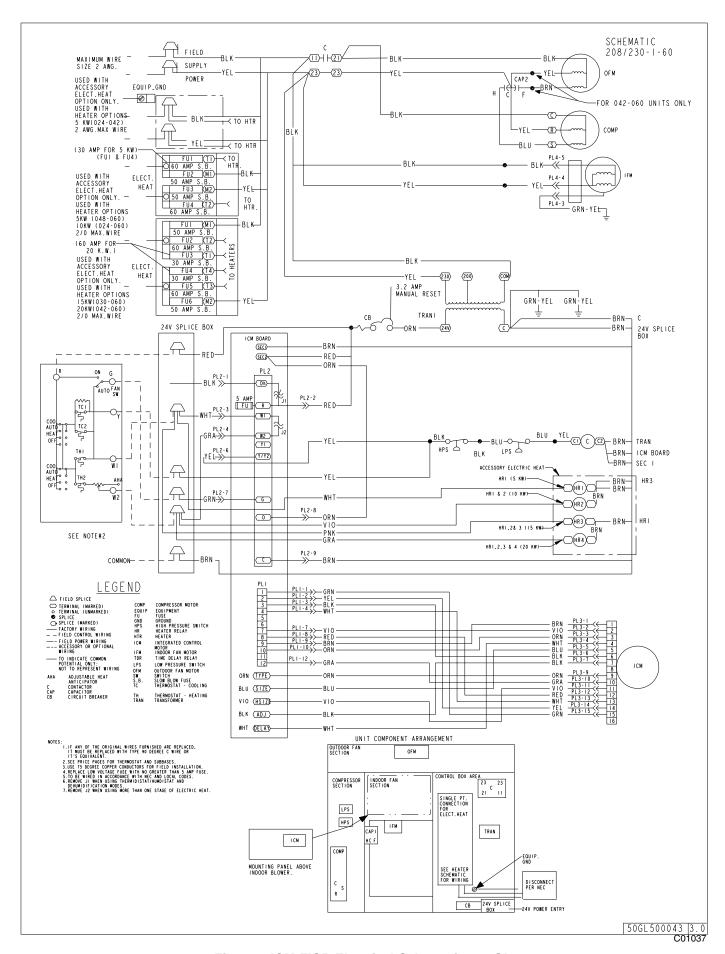
Fig. 16—ICM FIOP Electrical Schematic—50GL
